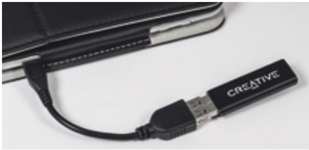
Кабель-переходник из комплекта поставки позволяет подключать к планшету периферийные устройства и портативные накопители
