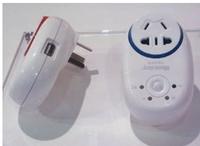
Устройство для отключения питания бытовых электроприборов через заданный промежуток времени. Сбоку есть розетка USB для подзарядки мобильных устройств
