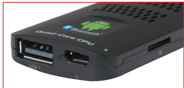
Расположение разъемов и слота карты памяти на корпусе Toucan Stick G3. Сверху находится объектив встроенной камеры
